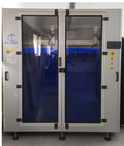
Figura 1. Imágenes de algunos de los equipos de fabricación aditiva de la DFA, perteneciente a los servicios centrales SC-ICyT de la UCA, que permiten trabajar con polímeros técnicos (a: Fortus 450mc, de Stratasys, y b: HT45, de Dynamical 3D) y en gran formato (c: Discovery 3D, volumen de impresión 3D de 1 m 3 ).
