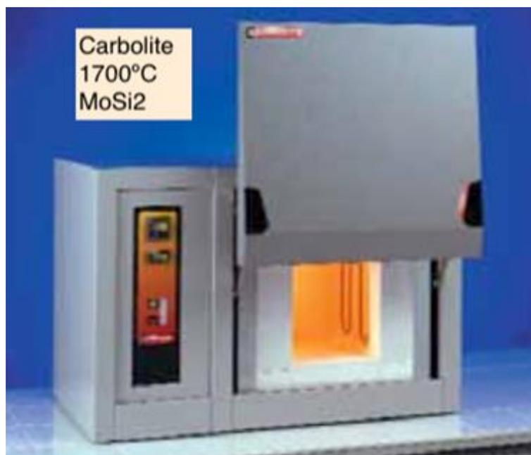
Cámara de 25 litros equipado con cuatro resistencias de disiliciuro de molibdeno.
