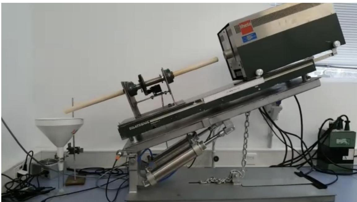
**Figura 2.** Detalle de la plataforma basculante con sistema neumático, con freno automático magnético y freno de emergencia mecánico de cadena. En esta imagen la plataforma se encuentra a la altura de la descarga, y el horno está en una posición en la que el reactor tubular queda completamente fuera de la sección del horno, con su extremo abierto orientado hacia un receptáculo que simula el enfriador diseñado que se encuentra en proceso de construcción.
