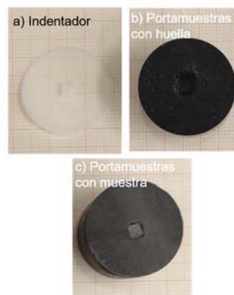
Fig.2. Imagen del sistema de indentación y portamuestras empleados en la fijación de los sustratos de materiales semiconductores al soporte del sistema de pulido Roto-Pol 35.
