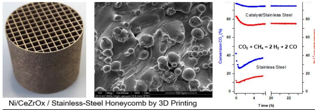
**Figura 1.** Fotografía de monolito honeycomb metálico fabricado por impresión 3D, imagen SEM de una zona de su superficie que muestra la rugosidad de ésta, y evolución con el tiempo de la conversión de reactivos en la reacción de reformado seco de metano para las muestras indicadas, operando a 900 °C, con una mezcla CH<sub>4</sub>:CO<sub>2</sub> 1:1 y una velocidad espacial (WHSV) de 115 L g<sup>-1</sup> h<sup>-1</sup>.
